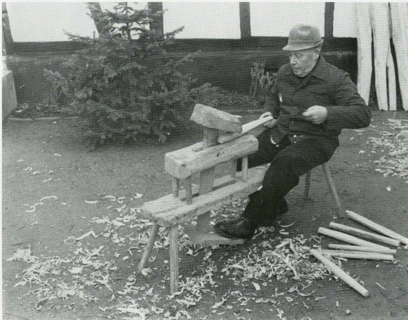
Zurichten der Sprossen auf der Fegebank. Foto: Verfasser
