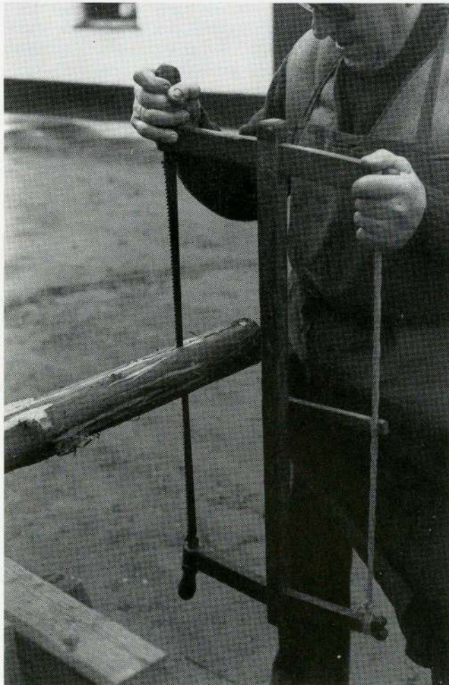
Zurichten der Sprossenrohlinge mit dem Flatschbeil und Herstellung der Holme mit der Spannsäge.
