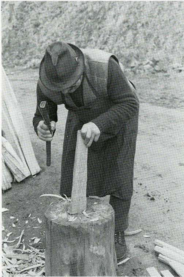
Zurichten der Sprossenrohlinge mit dem Flatschbeil und Herstellung der Holme mit der Spannsäge.
