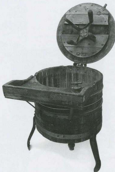
Bottichwaschmaschine der Marke Miele mit Handantrieb, um 1930-40 [5]
