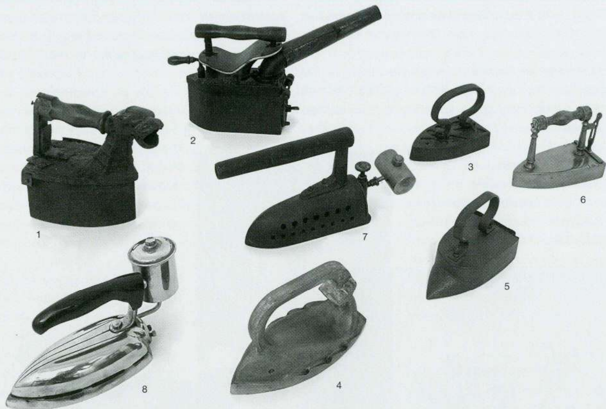
Verschiedene Bügeleisen: 1 und 2 Kohleisen, 3 und 4 Setzeisen, 5 und 6 Bolzeneisen, 7 und 8 Spirituseisen [9]
