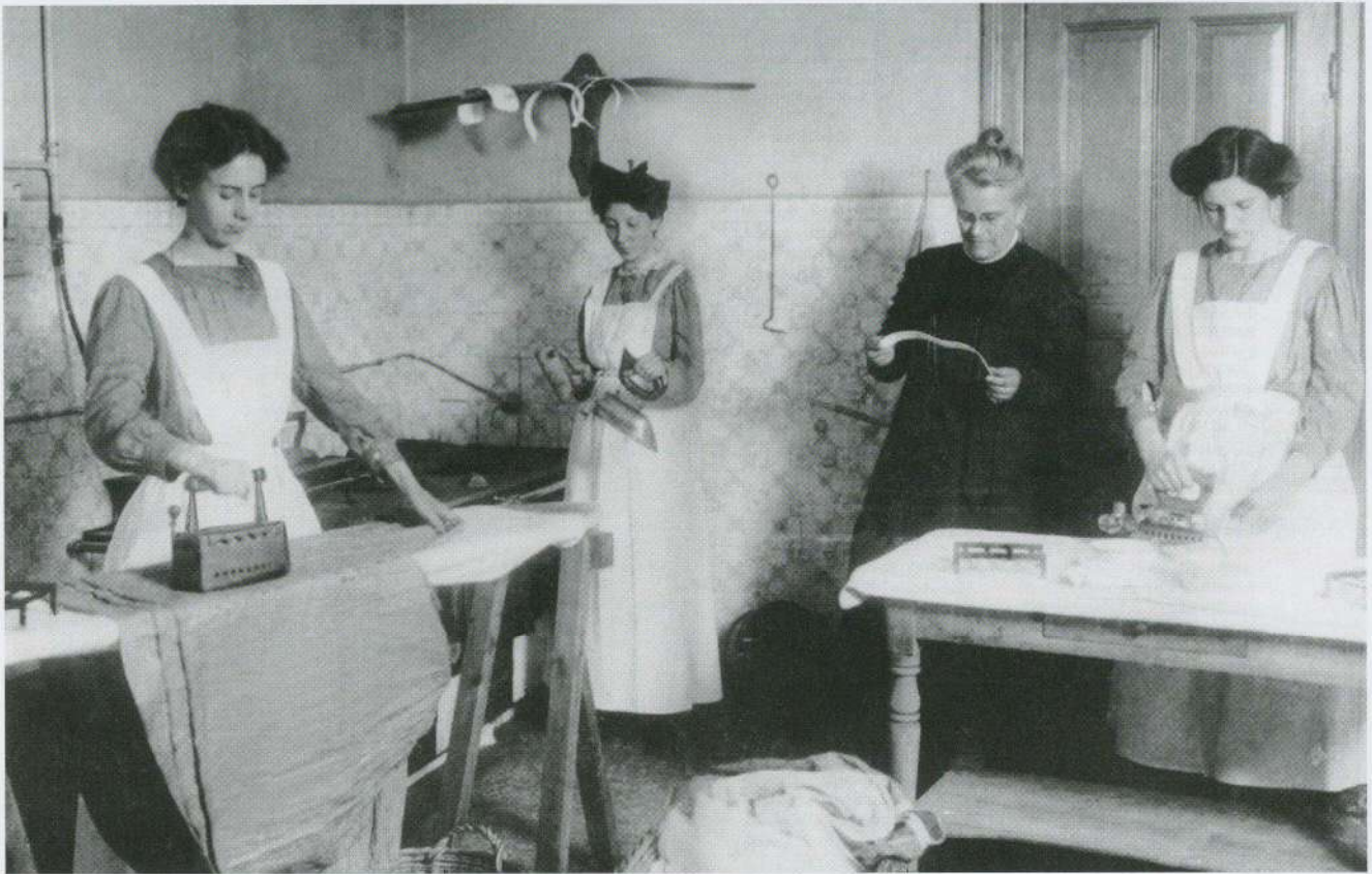
Verschiedene Bügeltechniken: Von links nach rechts Bügeln mit Holzkohleisen, mit Bolzeneisen und mit Spirituseisen; auf dem Herd Setzeisen und Brenner mit Gaseisen [11]
